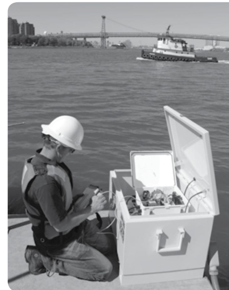
Ein Beispiel für ein NEMA-Gehäuse mit verdrahtetem DCP-Signalausgangadapter.
