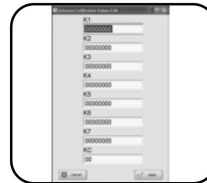
Obwohl in der Fabrik Maßnahmen ergriffen werden um dies sicherzustellen, sollte geprüft werden, ob die Seriennummer der Kalibrierungskoeffizienten des Anleitungsblattes mit der auf der Außenseite der Sensorkappe eingravierten Seriennummer übereinstimmt.
