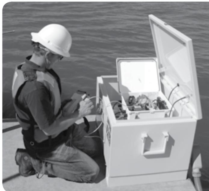
Ein Beispiel für ein NEMA-Gehäuse mit verdrahtetem PLC + Modbus-Adapter.
